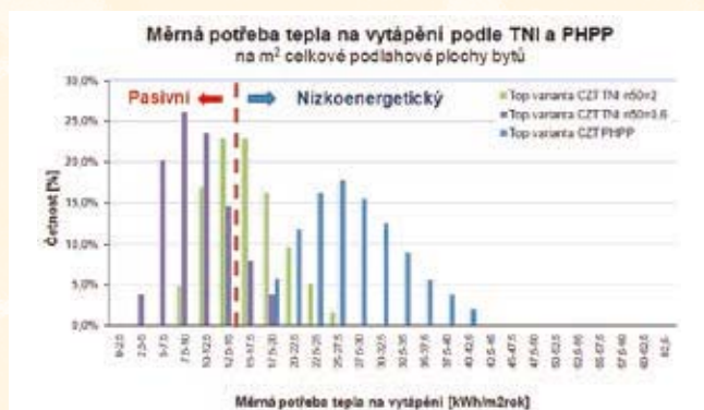
Obr. 3: Měrná potřeba tepla na vytápění u panelových domů podle TNI a PHPP pro různé varianty řešení. (EkoWATT)
