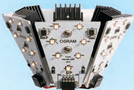
LED modul se skládá ze šesti desek, z nichž je každá osazena sedmi diodami. Tyto diody produkují teplé bílé světlo, podobně jako klasické žárovky.
