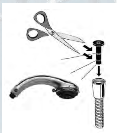
Obrázek 7: Nastavitelná sprchová hlavice a redukční kroužek pro omezení množství vody ve sprchové hadici a možnosti jeho úpravy. Zdroj: Grohe, Ideal standard.
